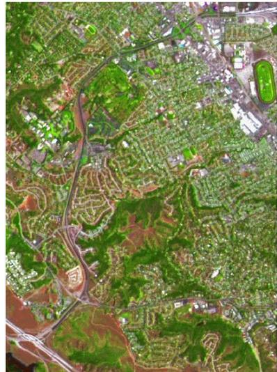
Despliegue RGBI de los mismos tres raster TM con un objeto SPOTPAN como Intensidad. El despliegue resultante combina la alta resolución espacial de la imagen SPOT pancromática con el contenido espectral de las bandas TM.
